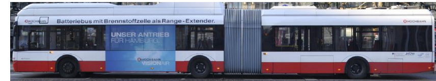
Fuel Cell Bus <10 min. fueling 400+km range 20-40 kg per fill
